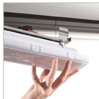
Montagem com fixações de encaixe. O cabo de retenção evita a queda em situações extremas
