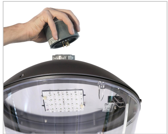
Conexão do controlador LUCO P7 CM na ficha NEMA 7 pinos
