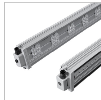
A ContiLED está disponível com dois conceitos fotométricos diferentes: LensoFlex®2 com módulos separados de 4 LEDs ou ContiFlexTM como uma única linha contínua de LEDs.
