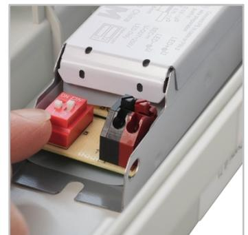
O driver da luminária pode ser equipado com um DIP switch que permite adaptar a iluminação a qualquer situação momentânea.
