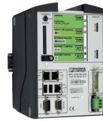
Desenvolvido em conjunto pela Schréder e a Phoenix Contact, o ATS 4 (Advanced Tunnel Solution 4), controla cada ponto de iluminação ou grupo de luminárias para adequar perfeitamente o nível de iluminação em função das condições do túnel, monitorizando o consumo de energia e relatando as horas de funcionamento e falhas para facilitar a manutenção. O sistema inclui auto comissionamento e permite a adaptação remota de cenários em qualquer momento.
