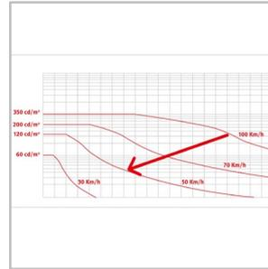
O ATS 4, pode ser ligada a um sistema de monitorização de tráfego para obter dados sobre a velocidade ou a densidade e adequar o nível de iluminação de acordo com as normas de segurança. Esta opção reduz ainda mais o consumo de energia e aumenta a vida útil da instalação, assegurando simultaneamente as melhores condições de condução para os condutores.
