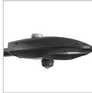
A tomada Zhaga é pequena e adequada para aplicações em que a estética é essencial. A arquitetura Zhaga-D4i também prevê a possibilidade de colocar duas tomadas numa luminária, permitindo, por exemplo, a combinação de um sensor de deteção e um nó de controlo. Isto tem o valor acrescentado de normalizar certas comunicações de sensores de deteção com o protocolo D4i.
