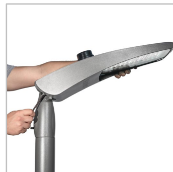
Ajuste da inclinação no local: post-top (0 a +15°); lateral (0 a -15°).
