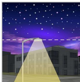
O rácio de luz para cima (ULR) e o rácio de saída de luz para cima (ULOR), este último tendo em conta o fluxo da luminária, fornecem informações sobre a percentagem de luz emitida em direcção ao céu. Esta gama de luminárias Schröder minimiza ou elimina (dependendo das opções) o fluxo luminoso para cima. Cumpre os rigorosos requisitos internacionais e locais.
